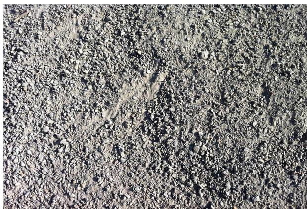
Ilustración 4. Árido reciclado de hormigón.
