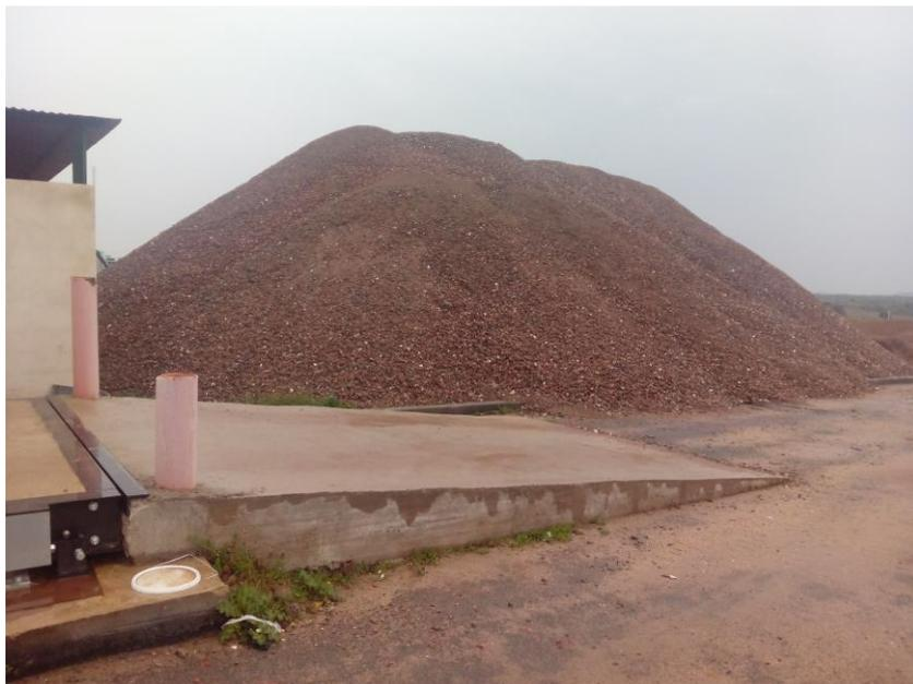
*Ilustración 6. Acopio de árido reciclado en una planta de reciclaje de RCD.*
